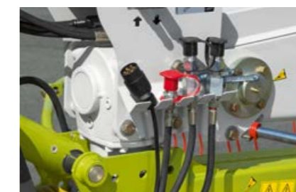
Standaard met volgordschakeling voor het instellen van de vertraging bij heffen en zakken tussen de voorste en de achterste rotor
