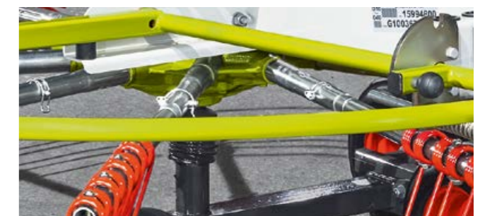
Verbinding met Citroënprofiel en klembus bij de LINER 370
