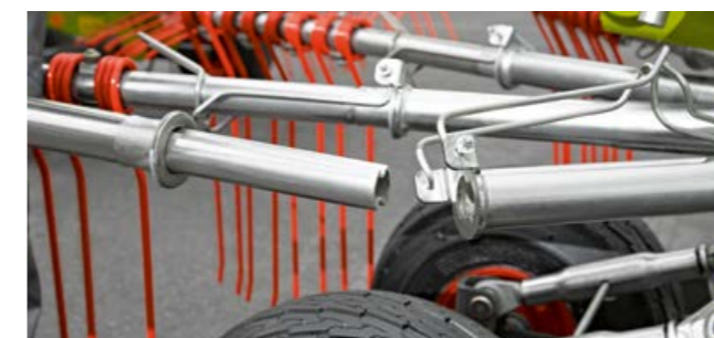
Verbinding met Citroënprofiel en PROFIX tandarm beveiliging bij de LINER 700
