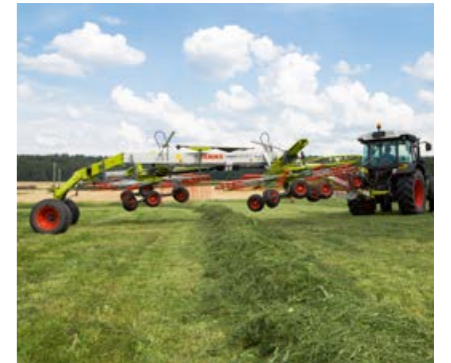
Harken als een professional: grootste hefhoogte om gemakkelijk over het zwad te rijden
