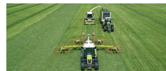
Om de JAGUAR optimaal te belasten, heeft CLAAS in 1998 wereldwijd de eerste zwadhark met vier rotoren aangeboden en biedt nu met twee modellen maximale slagvaardigheid voor de professionele sector.
