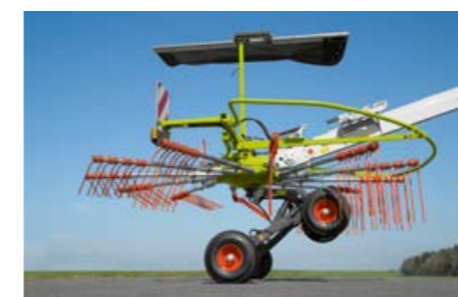
Grote hefhoogte om over zwaden op de wendakker te rijden: tot 60 cm bij de LINER 700 TWIN
