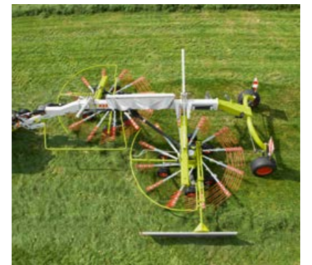
Schone overname van het voer van de eerste naar de tweede rotor
